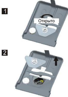
Шаг 2: Поднимите блок фильтров вверх
